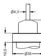
Kabelausgang mit PVC-Kabel (IP 67)<sup>4</sup>
