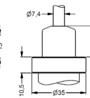
Kabelausgang, Kabel mit Belüftungsschlauch (IP 68)<sup>5</sup>
