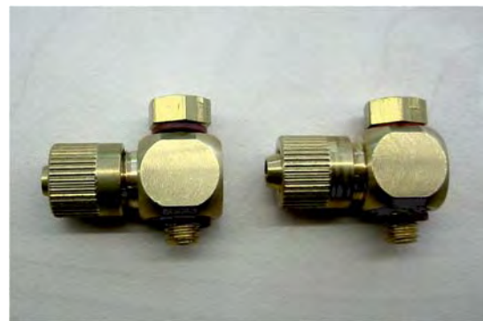
L-Schnellverschraubung aus Messing schwenkbar, DN 2,3, M5 x 6,2/4 mm L-form quick connector in brass rotatable, DN 2.3, M5 x 6.2/4 mm
