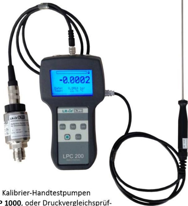
Zusammen mit einer geeigneten Kalibrierdruckquelle, z.B. den Kalibrier-Handtestpumpen **LR-Cal LPP 40**, **LR-Cal LPP 60**, **LR-Cal LPP 700** oder **LR-Cal LPP 1000**, oder Druckvergleichsprüfpumpen **LR-Cal LPP 60-T** oder **LR-Cal LSP** ergibt der Druck- und Temperatur-Kalibrator **LR-Cal LPC 200-T** ein präzises und dabei mobiles Kalibriersystem.
