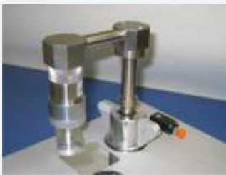
Beim Vakuum-Bereich werden die Massen an einer Galgenkonstruktion eingehängt. For vacuum operation, special masses are to be placed at some kind of gibbet construction.
